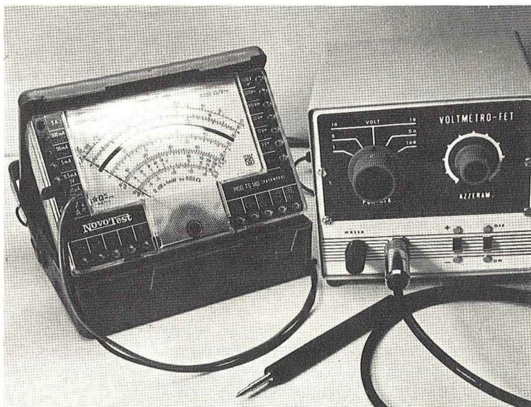
**A coloro che posseggono un normale tester e non possono, o non vogliono oberarsi della spesa di un voltmetro elettronico, consigliamo di realizzare questo circuito, che senza modificare alcuna parte dello strumento, lo tramuterà in un efficientissimo voltmetro elettronico con una resistenza d'ingresso vicinissima ai 30 megaohm.**
